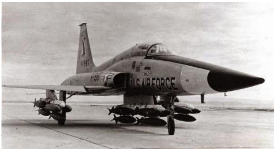
Nem todos ouviram falar, mas os F-5 podem ser equipados com *Multiple Ejector Racks* (MER) e/ou *Triple Ejector Racks* (TER), com bombas de 500 lb, como pode ser visto na foto acima.
